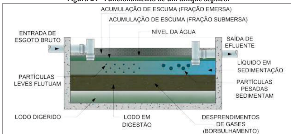
Figura 21 - Funcionamento de um tanque séptico.
