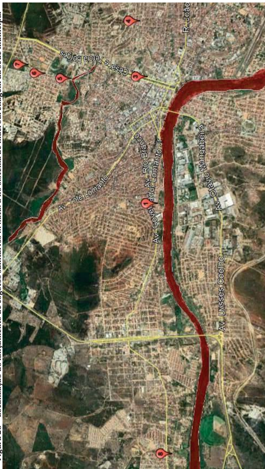
Figura 23 – Localização do lançamento de esgotos sanitários in natura no sistema de macrodrenagem da sede municipal
