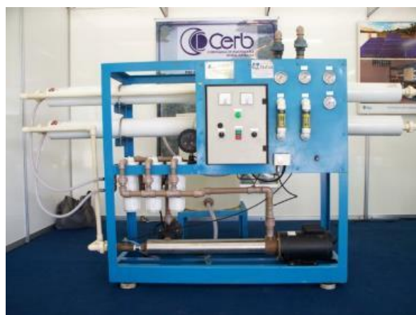
Figura 134- Dessalinizador de água por osmose reversa
