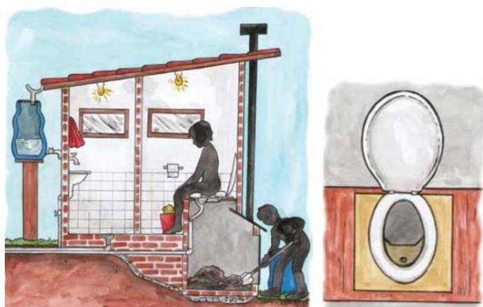
Figura 156 – Banheiro seco com bacia sanitária segregadora de urina
