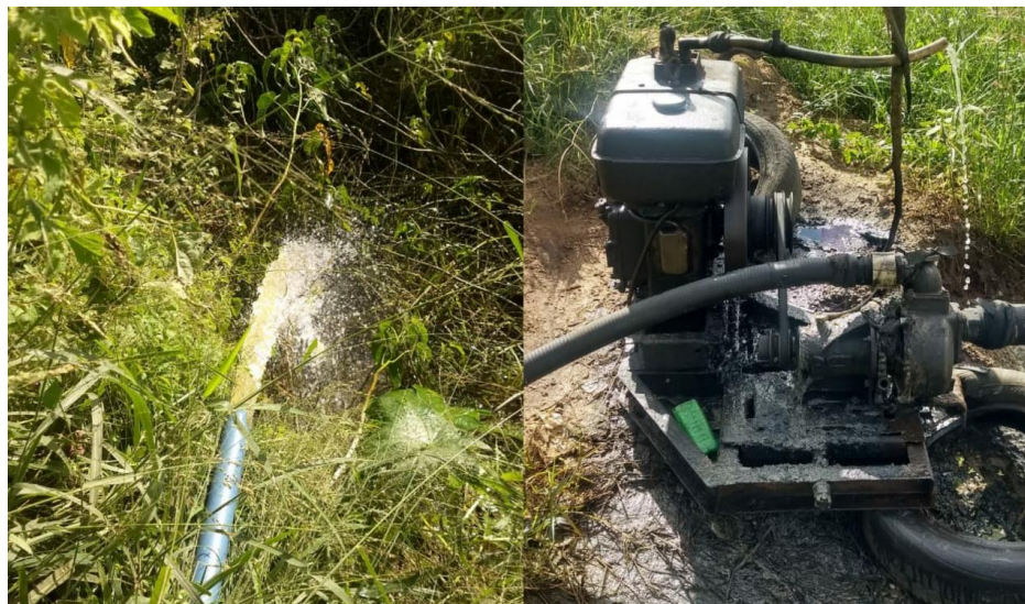
Figura 73- Equipamento Utilizado par bombeamento do esgoto Tratado em Boa Vista do Tupim/BA
