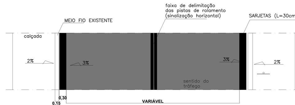
\*\*\*OBS.: EM TODOS OS TRECHOS DE RECAPEAMENTO ASFÁLTICO, SERÁ CONSIDERADO UMA SARJETA DE 30 CM DE LARGURA, SOB O PAVIMENTO EXISTENTE EM AMBOS OS LADOS, APROVEITANDO O MEIO-FIO E PAVIMENTO JÁ EXISTENTE COMO SARJETA, ASSIM COMO INDICADO EM PLANTA DE DETALHAMENTO.
