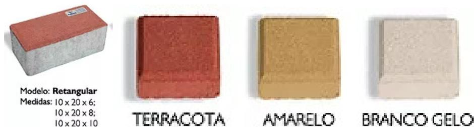
3.2.1. Os locais indicados, serão pavimentados com lajotas de cimento intertravado, tipo retangular de 6cm de espessura. Os pisos devem ser assentados sobre colchão de pó de pedra, devidamente nivelada e compactada, obedecendo aos níveis e declividades recomendadas.
