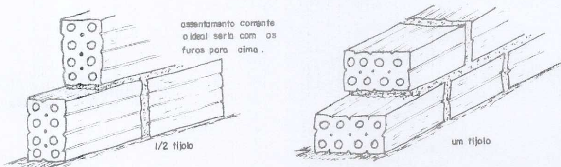
Figura - Execução de alvenaria utilizando tijolos furados
