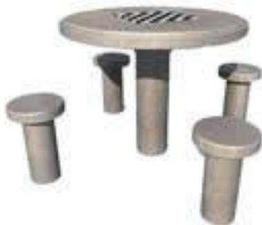
Mesa de concreto pré-moldado com tabuleiro para jogos. A mesa será em concreto armado aparente, sem revestimento. Não serão aceitos elementos de concreto que não apresentem uniformidade de coloração, homogeneidade de textura, regularidade das superfícies e resistência ao pó e agressões ambientais em geral. Serão fixados no solo através chumbamento com uma camada fina de concreto.
