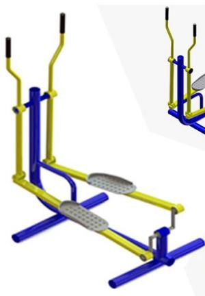
Equipamento produzido a partir de tubos e chapas em aço carbono de alta resistência, sob dimensões de 2" ½, 1" ½, 1", 3/8 com espessuras mínimas de 2,00 mm; assento em chapa 14; orifícios tubulares: extremidades superiores e inferiores blindadas em chapa 14, tornando-o insensível a penetração de água; utilizando eixos maciços e usinados para rolamentos duplos (Tipo ZZ).
