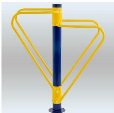
Estrutura principal em tubo redondo de 127 mm na chapa 14, estrutura secundária em tubo de 1 ¼" na chapa 14. Os tubos recebem galvanização, proporcionando assim beleza e durabilidade. Este módulo requer chumbamento ao solo.
