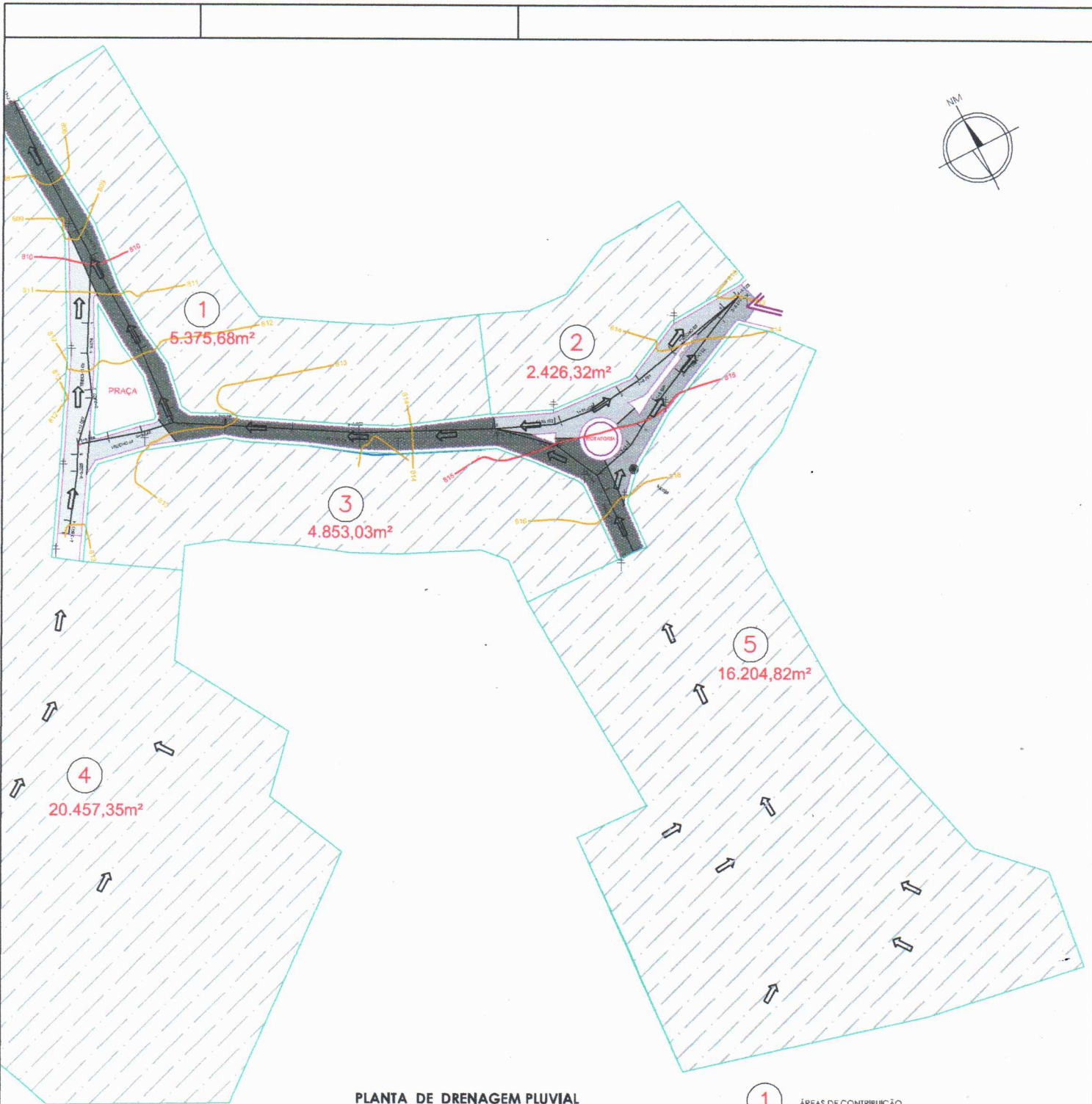
PLANTA DE DRENAGEM PLUVIAL ESCALA 1/1000
