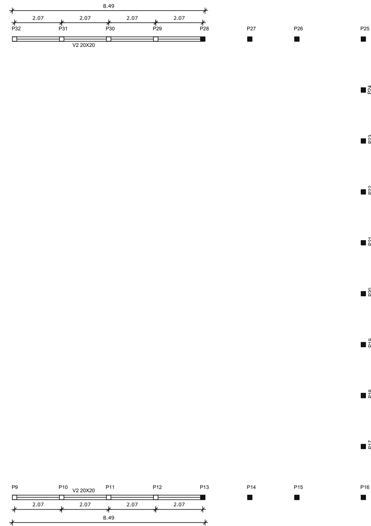
FORMA DO PAVIMENTO NIVEL 2 ESCALA 1:100
