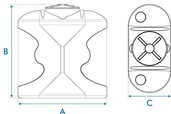
**A** Comprimento      **B** Altura com tampa      **C** Largura
