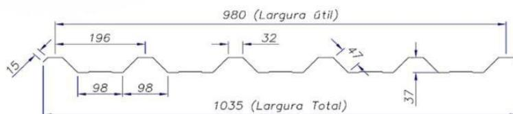
Figura 11 – imagem telha metálica trapezoidal TP40-980
