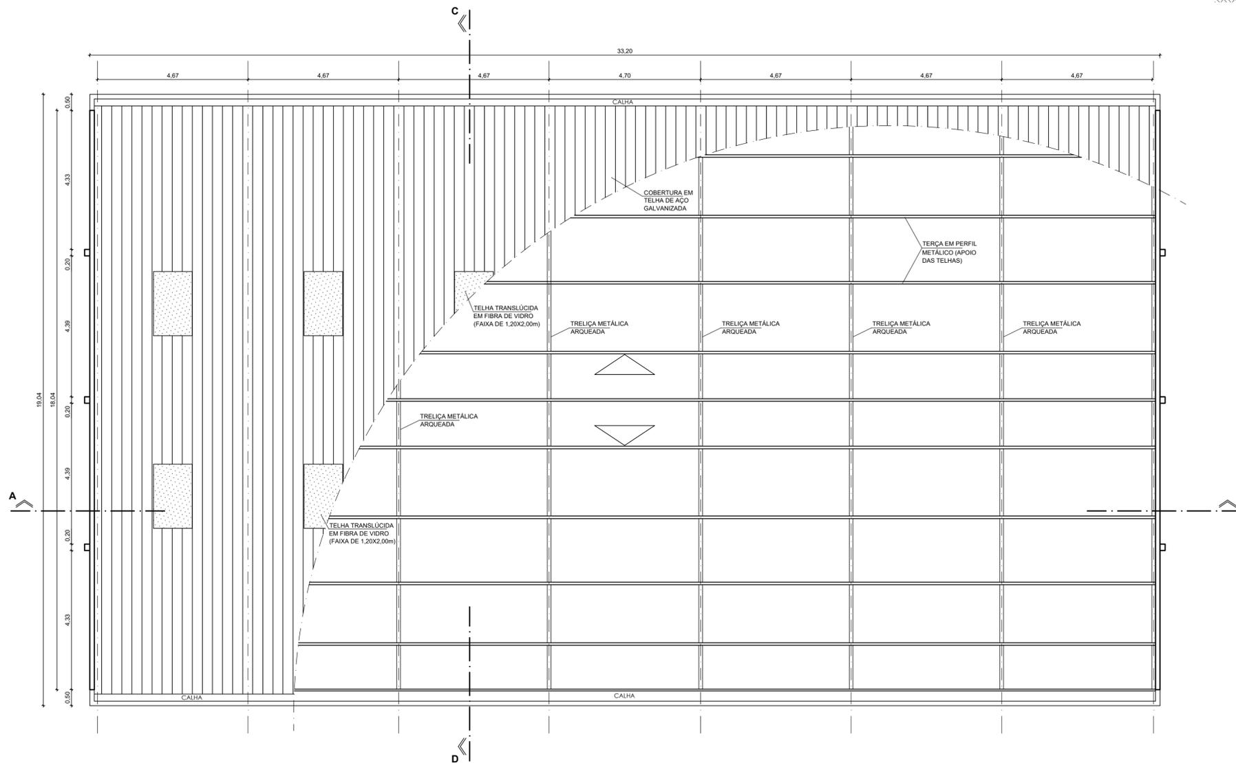
PLANTA DE COBERTURA - DIAGRAMAÇÃO DA ESTRUTURA DO TELHADO
