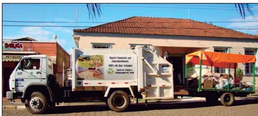
Figura 9.9 – Carroceria adaptada para coleta seletiva.
