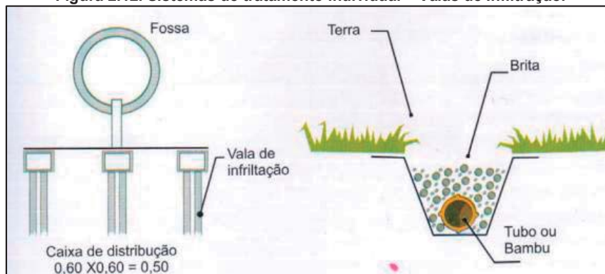
Figura 2.12. Sistemas de tratamento individual – Valas de Infiltração.
