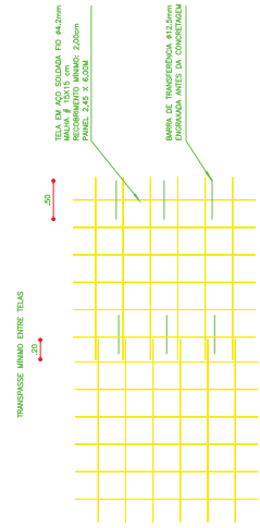
5 Detalhe 01 - Armadura da Tela ESCALA 1/20
